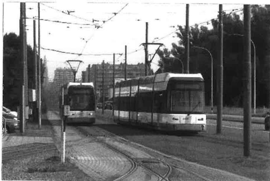
Vue du terminus (Linkeroever) côté Escaut et centre ville ; on constate ainsi que ce terminus- point d'arrêt comporte trois voies de réception et une voie de départ.
